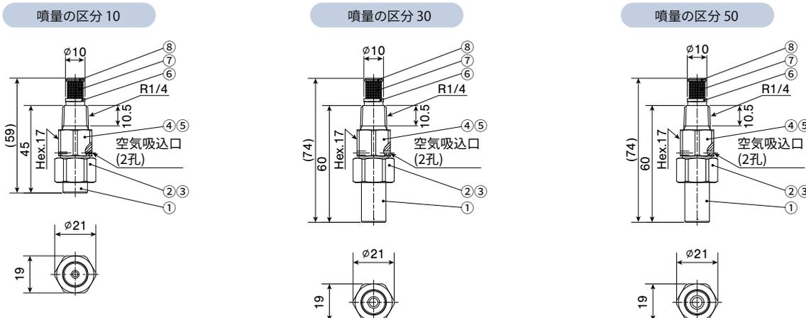
①ノズルチップ ②キャップ ③ストレーナー・スクリーン ④アダプター ⑤ホイラー ⑥ストレーナー・ホルダー ⑦ストレーナー・スクリーン(#50) ⑧ストレーナー・キャップ
