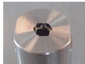
スラリー液による噴口部の摩耗
