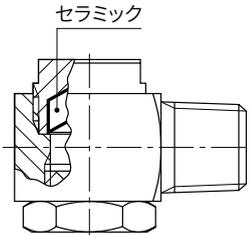
●ノズル本体底部にセラミック材を使用した空円錐ノズル。
