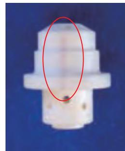
急冷により亀裂が入ったノズル
