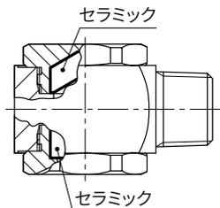
●ノズル本体底部および噴口部にセラミック材を使用した空円錐ノズル。
