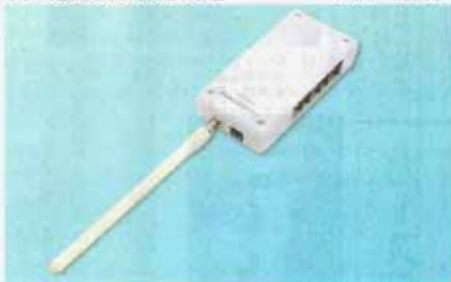
装置トラブルを防ぐため遠隔監視用に自社開発したIoT機器
