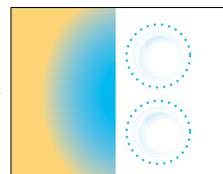
霧の粒子が速やかに気化、熱を奪われたところの温度が低下し、涼感だけが残ります。
