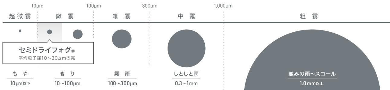
注) インサートノズルは、ドライフォグの中でも「冷房」「演出」に適した、セミドライフォグを発生させます。
