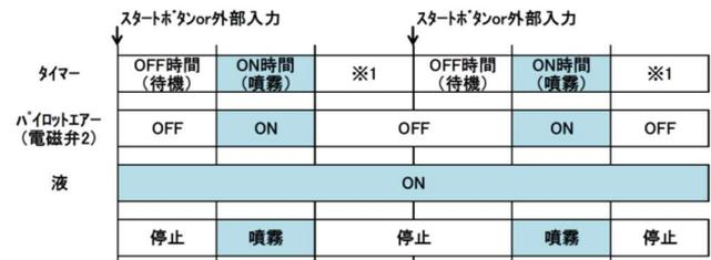
※1 操作盤内の外部入力の端子をジャンパーすると、※1 の区間がなくなり、OFF・ON を繰り返します。
