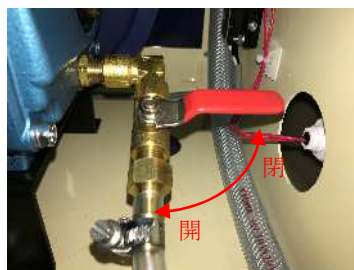
KYZ75G-4IK-S1CFS-P、KYZ150G-9IK-T2CFS-T、KYZ220G-13IK-T2CFS-T はポンプの後ろ側にあります。
