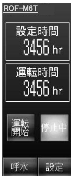
電源立ち上げ時は停止中が選択されており、停止中が点灯します。
