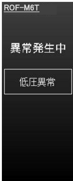
原水圧が低下し、低圧スイッチが作動した際に
