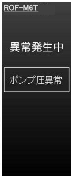
RO膜に加わる圧力で異常な数値を示した際に圧力スイッチが不具合を感知し、画面が切り替わり、警報アラームが鳴り停止します。
