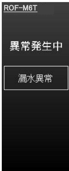
純水装置内で水漏れが発生し、漏水センサーのフロートスイッチが反応した際に画面が切り替わり、警報アラームが鳴り停止します。
