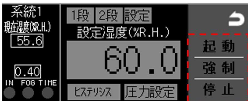
各系統の湿度設定画面右側にある「起動」「強制」「停止」ボタンを押すことで装置を運転したり、停止させたりすることができます。
