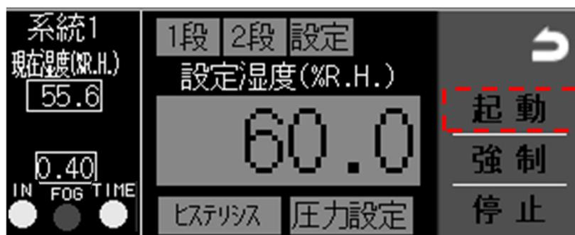
各系統別に設定した以下の噴霧開始条件が全て揃うと、対応する系統の噴霧が開始します。自動運転中は現在湿度に応じて噴霧圧力を調整します。
