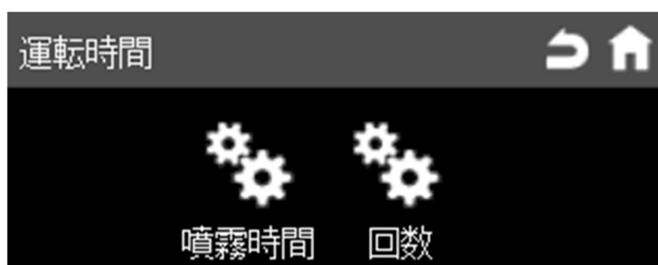
パイロット電磁弁を交換し、リセットボタンを2秒以上長押しすると、積算時間を0に戻すことができます。
