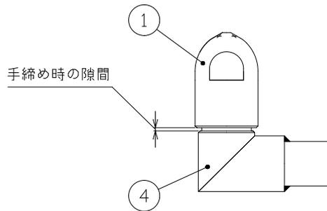
手締め時の隙間：2mm
